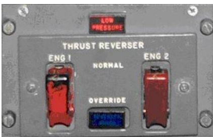
تصویر هشت - نشان‌دهنده عملکرد سامانه thrust reversal در اتاقک خلبان
