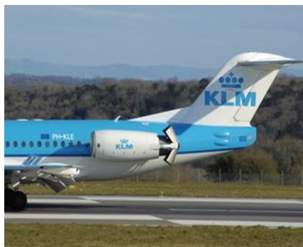
تصویر چهار - استفاده از bucket در انتهای موتور یک فروند فوکر ۱۰۰
