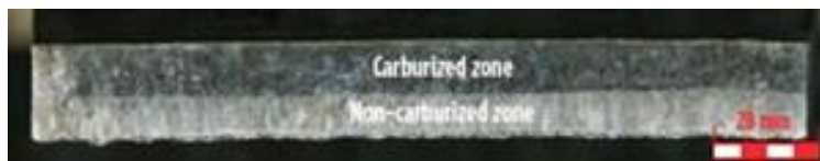
نمونه ای از کربوریز شده یکنواخت، شکل ۲
