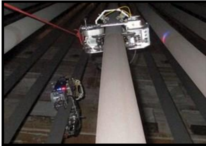
شکل 45Ni-35Cr4 ربات بازرسی کربوریزاسیون در حال بررسی لوله تابان
