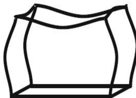
شکل ۱۰. مخزن فشار منشوری تغییر شکل یافته [۱۱]
