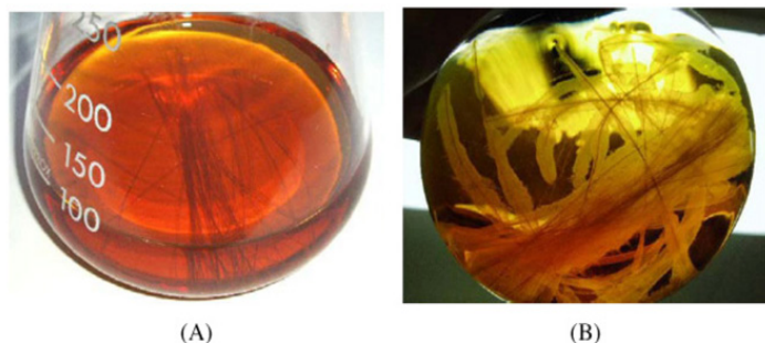
شکل ۳. (A) الیاف طبیعی غوطه‌ور در محیط کشت گلوکون استوباکتر زایلینیم ۵ قبل از کشت باکتری (B) محیط کشت پس از ۲ روز [۶۰]
