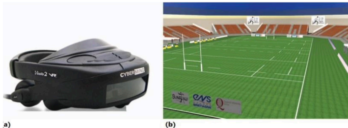
شکل ۴. دستگاه مورد استفاده برای مطالعه موردی راگبی: (a) HMD محیط راگبی مجازی، ترکیبی از این فناوری‌های سخت‌افزاری و نرم‌افزاری امکان غوطه‌وری کامل از بازیکنان را در زمین راگبی مجازی فراهم می‌کند [۳].
