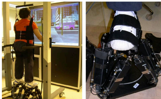
شکل ۱. شمایی از دستگاه توان‌بخشی ۶ درجه آزادی روتگرز [۱]
