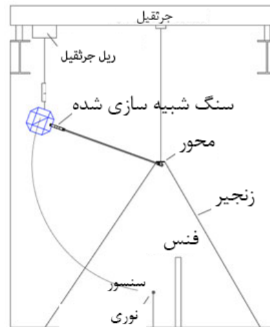
شکل (۳) پلان کلی آزمایش های شبیه سازی برخورد سنگ به فنس
