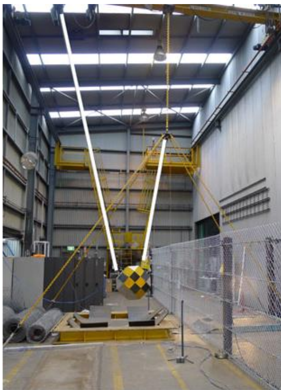
شکل (۲) نمایی از تجهیزات و فضای آزمایش های شبیه سازی برخورد سنگ به فنس
