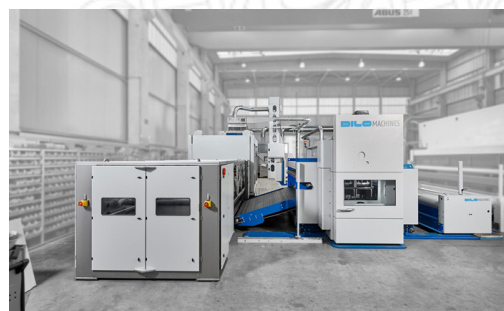
ماشین سوزن زنی شرکت دیلو - دستگاه طرح زنی دیلو (Di loop) مستقر در شرکت موکت همدان
