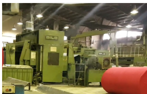
ماشین سوزن زنی شرکت دیلو - دستگاه طرح زنی دیلو (Di loop) مستقر در شرکت موکت همدان
