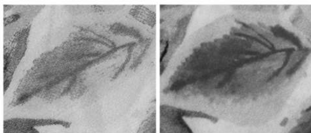
شکل ۱- طرح چاپ بر پارچه‌ی پنبه‌ای (الف) چاپ دیجیتال (ب) چاپ توری
