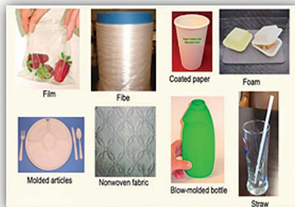
شکل ۲: پلیمرهای نوداکس برای تولید انواع محصولات نهایی با نرخ تجزیه زیستی مشابه سلولز یا ضایعات مواد غذایی استفاده می‌شود.
